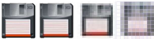
Rys. Ten sam rysunek (w powiększeniu) z różnymi rozdzielczościami – od lewej: 300dpi, 72dpi, 20dpi, 10dpi
